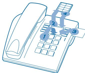
1. Insérez un objet à bout plat dans l'encoche (1 encoche par bloc de touches).
